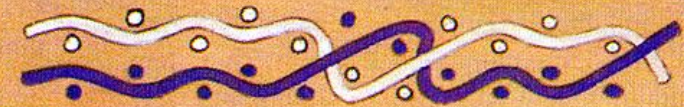
Ligamento de tela doble. En el corte se aprecian las dos series de urdimbre y el punto en que se unen.
